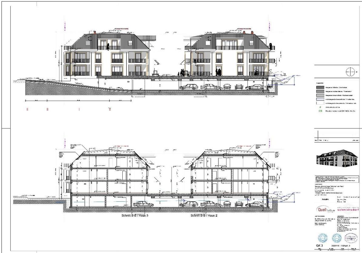
**Abb. 4: Schnitte der geplanten Gebäude** (Quelle: Architekturbüro Schmidtsdorf)
