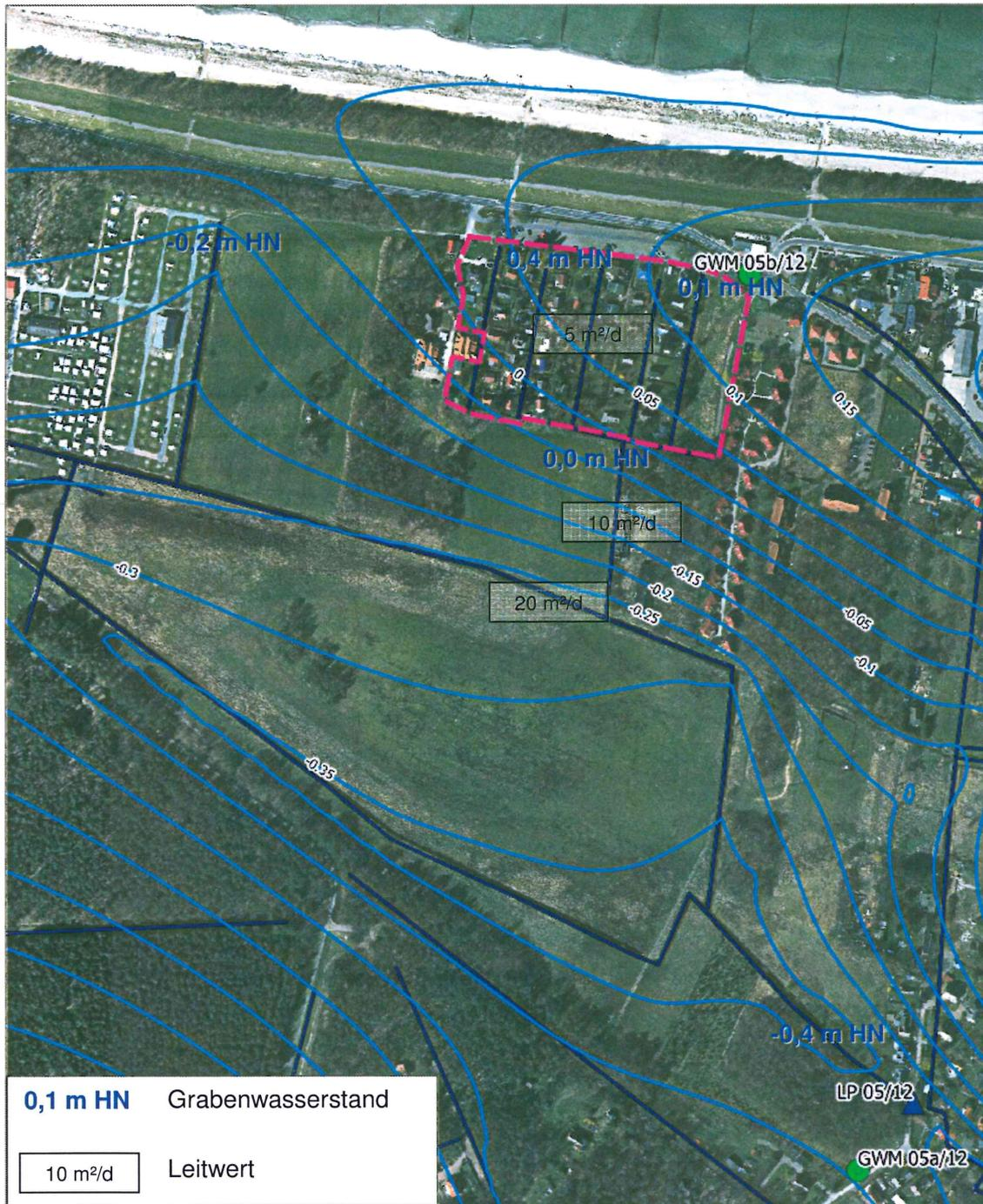
Abbildung 4: Parametrisierung der Gräben und Grundwassergleichen [m HN]
