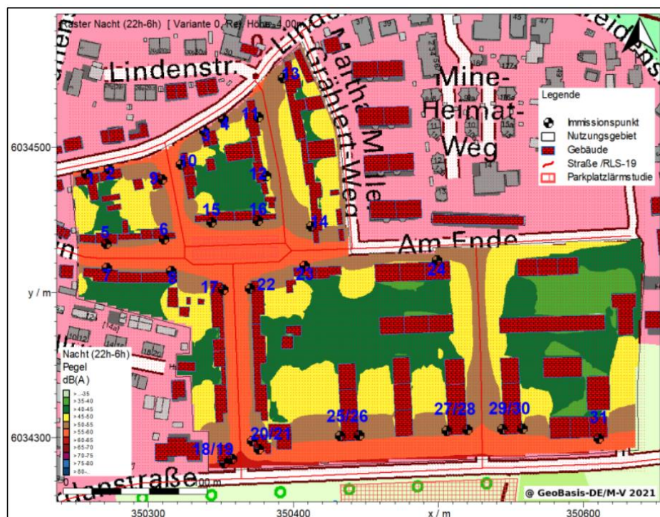
Abbildung 4: Flächendarstellung der Schalldruckpegel nachts im Bereich des Gebietes des geplanten Bebauungsplanes Nr. 37 der Gemeinde Ostseeheilbad Zingst, (Quelle: Ingenieurbüro Oldenburg GmbH, 2021)
