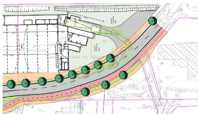
Abbildung 14: Schleppkurvenbefahrung vorwärts vom Betriebsgelände, IPO Unternehmensgruppe GmbH 2023
